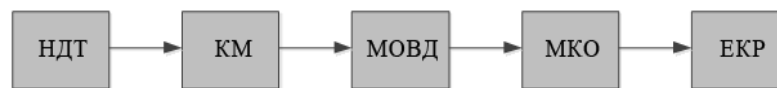
Рис. 1. Структурна схема системи вимірювання температури НДТ – набір датчиків температури; КМ – комутатор каналів вимірювання температури; МОВД – мікросхема обробки вхідних даних; МКО – мікросхема кодування та обробки; ЕКР – екран
