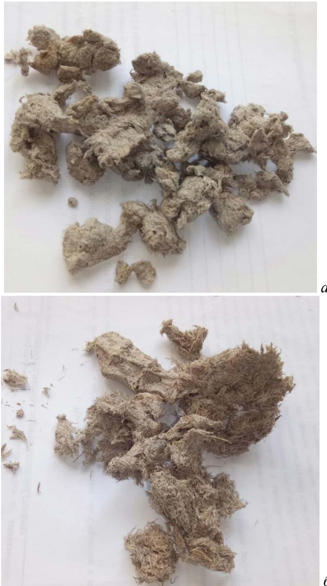
Рис. 2. Волокнисті напівфабрикати, одержані натронним варінням відходів переробки цукрової тростини: а – багаси; б – соломи
