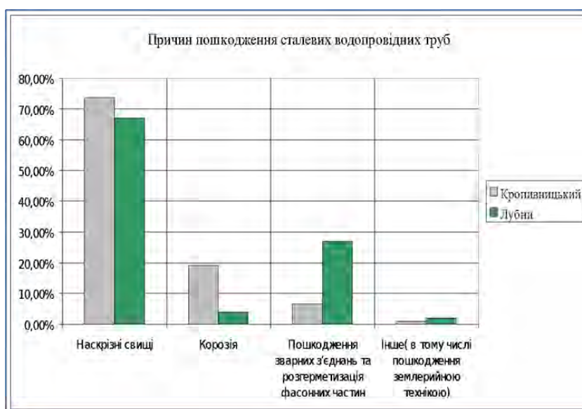
Рисунок 1. Порівняльні діаграми пошкодження сталевих водопровідних труб
