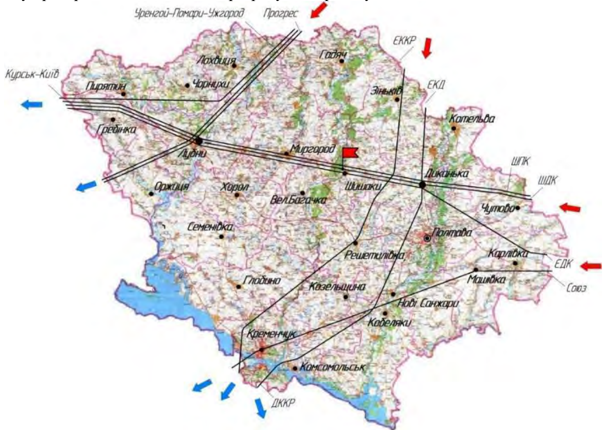
Рисунок 2. Проходження магістральних газопроводів Полтавської області через лісові масиви
