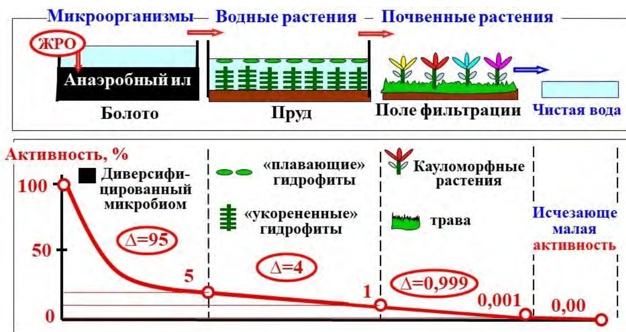
Рисунок 8. Теоретическая модель трехмодульной фитобактериальной экосистемы для очистки жидких радиоактивных отходов (ЖРО), где активность, % – суммарная \lambda , \beta и \lambda активность радионуклидов в ЖРО; \Delta – снижение активности, %.
