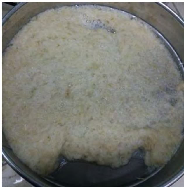
Рисунок 5. Промита та відбілена паперова маса
