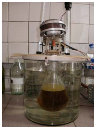
Рис. 1. Дослідна лабораторна установка для проведення реакції переестерифікації
