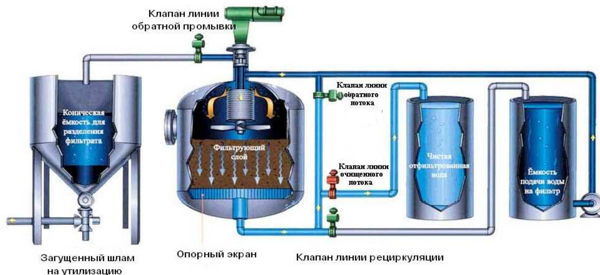
Рис.1. Система Hydromation с фильтрующим слоем из измельченной ореховой скорлупы
