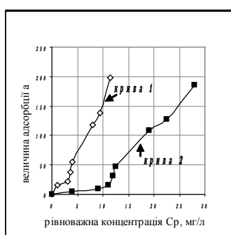
Рис. 1. Ізотерма адсорбції тритону X-100 та ОП-10 на активованому вугіллі АГ-3
