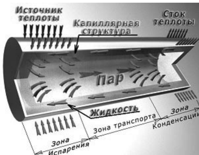
Рис. 1. Схема конструкції теплової труби та її роботи
