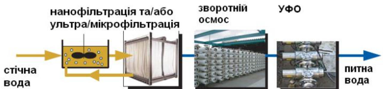
Рис. 2. Схема очищення води з використанням мембранних методів
